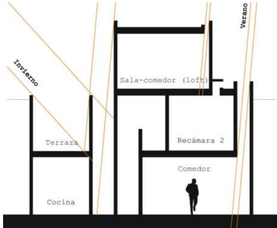
FIGURA 138. Sección transversal en esquema de iluminación natural.
