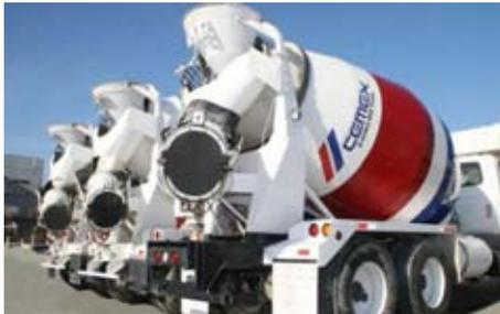
FIGURA 2.5. Camión revolvedor
