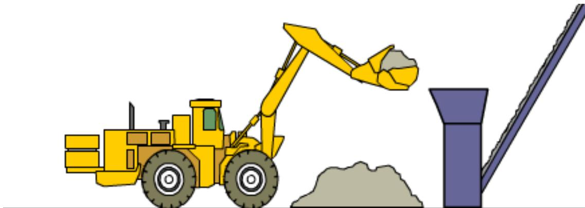
FIGURA 2.10. Incorporación de Agregados
