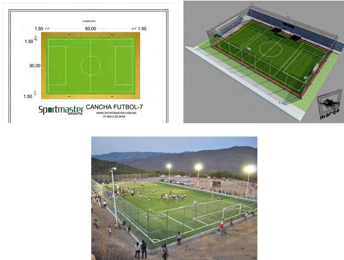
FIGURA 140, 141 y 142. Medidas básicas para la cancha de futbol siete o pasto sintético y sus principales adecuaciones en el sitio como mallas, alumbrado, etc.
