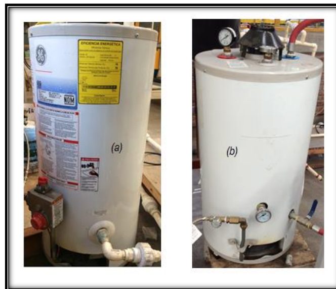
Figura 46. Calentador que simula un pozo geotérmico.
