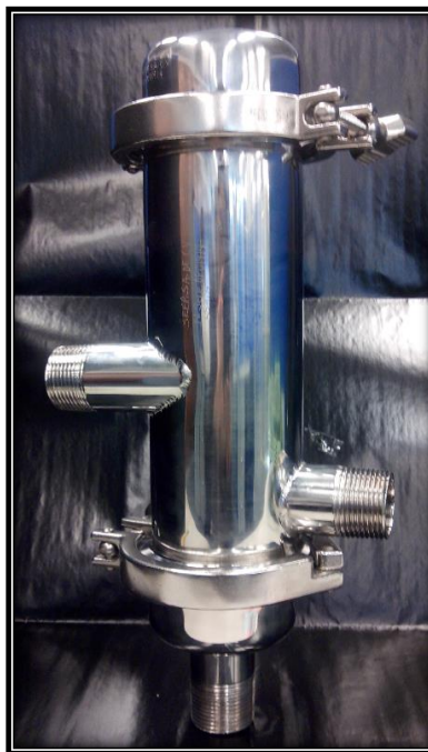
Figura 50. Separador de flujos manufacturado en acero inoxidable.
