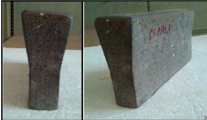
Figura 3.1. Representación del Bloque ``Y`` de fundición.
