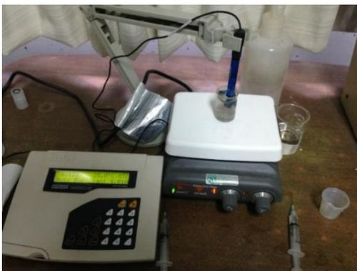
Figura 2.7 Acondicionamiento del mineral con pH-metro Oakton, previo a las pruebas de potencial zeta.
