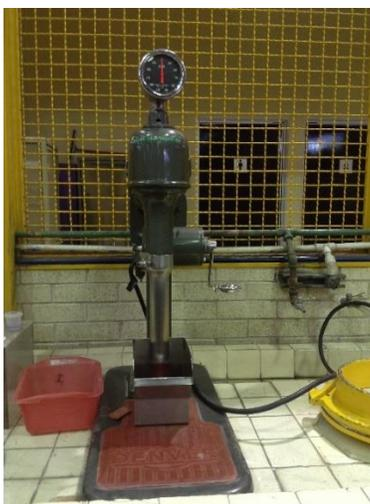
Figura 2.13 Celda de Flotación Denver.
