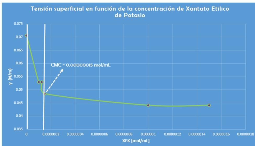
Figura 3.2 Determinación grafica de la concentración micelar critica con la tensión superficial de varias concentraciones de xantato etílico de potasio.
