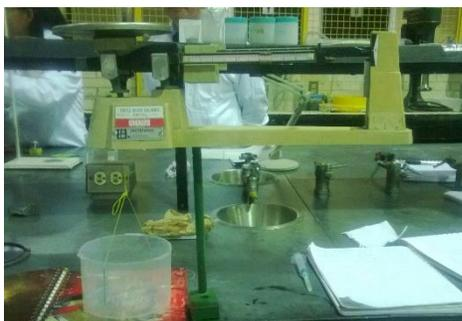
Figura 2.5 Dispositivo utilizado para medir la tensión superficial en la solución de XEK.
