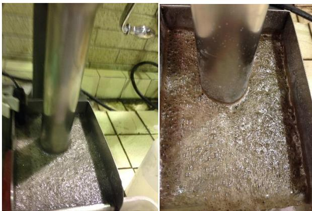
Figura 2.15 Circuito de flotación. Izquierda: Circuito Primario de Plomo. Derecha: Circuito Primario de Zinc.
