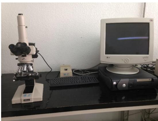
Figura 2.9 Microscopio de luz reflejada, Nikon Optiphot.
