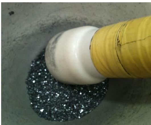
Figura 2.2 Pulverización del mineral en el mortero de porcelana.
