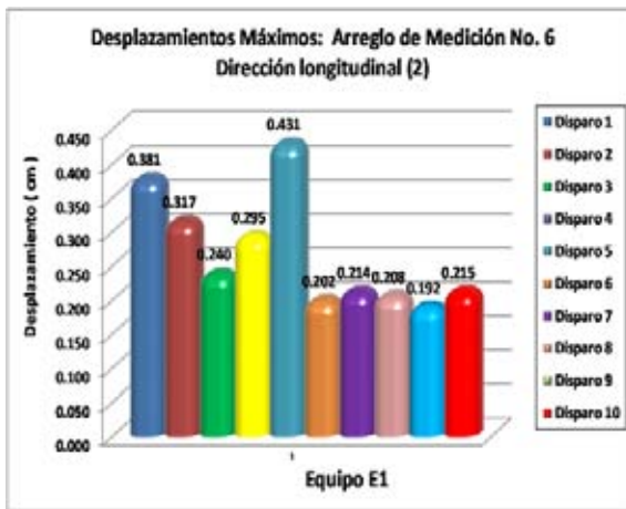
Fig. 5.13. Desplazamientos máximos obtenidos del equipo E1, en sus direcciones longitudinal (2) y transversal (3), del Arreglo No.6.
