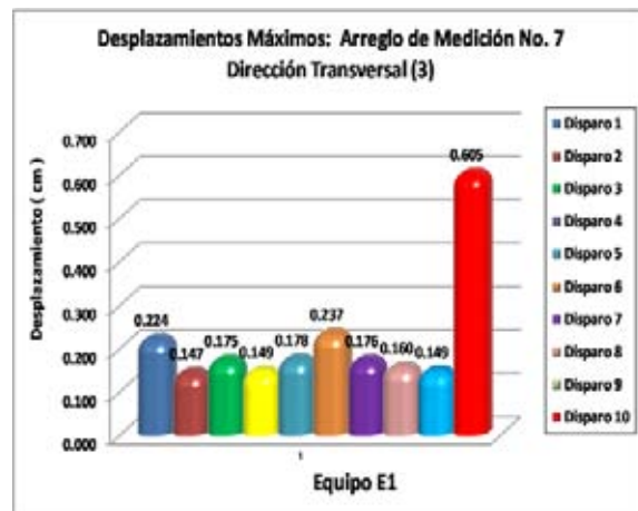
Fig. 5.19. Desplazamientos máximos obtenidos del equipo E1, en sus direcciones longitudinal (2) y transversal (3), del Arreglo No.7.
