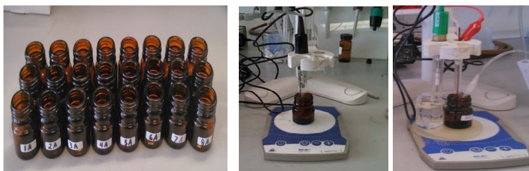
Figura 2.14. a) Curva de calibración con sus réplicas para pruebas potenciométricas, b) Pruebas potenciométricas con ESIS comercial, c) Pruebas potenciométricas con ESIS fabricado
