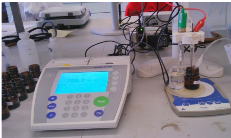
Figura 3.2. Montaje de equipo para la medición potenciométrica en pruebas de validación
