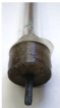
Figura 2.16. Electrodo tratado electroquímicamente
