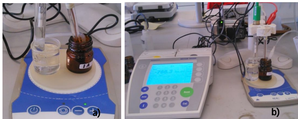
Figura 2.13. a) Celda electroquímica para pruebas potenciométricas con el ESIS fabricado. b) Montaje de equipo para pruebas potenciométricas con ESIS fabricado.
