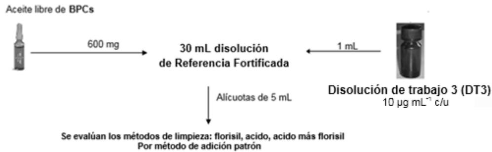
Figura 16. Preparación de la disolución de referencia fortificada
