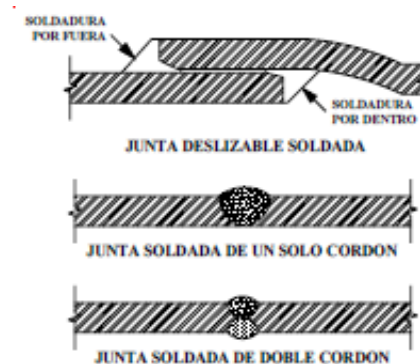
Figura 2.18.6.1 Uniones por soldadura
