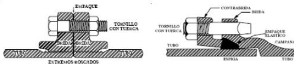
Figura 2.18.4.1 Unión de tipo bridada y mecánica
