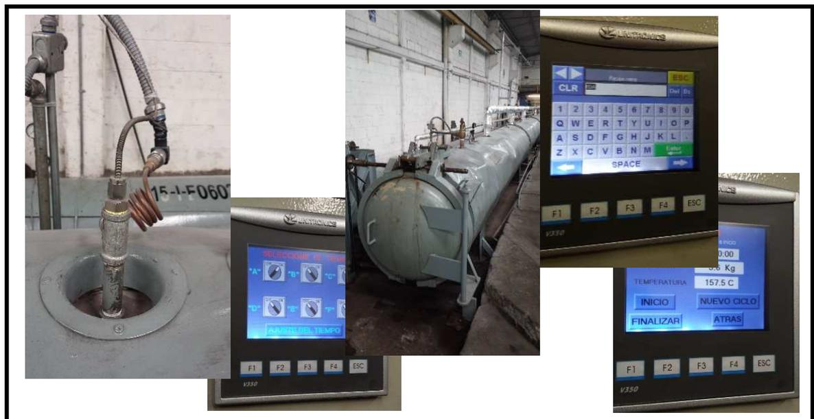
***Figura 3.9. Automatización de la autoclave de vapor***
