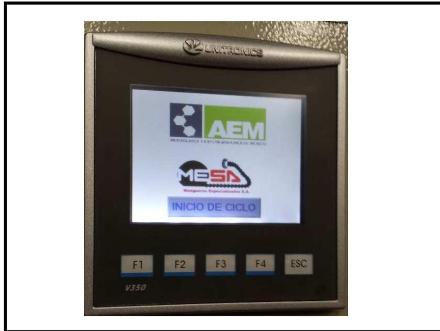
*Figura 3.3. Pantalla de Inicio que se colocó dentro en el PLC (Controlador Lógico Programable), para inicio de un ciclo de*
