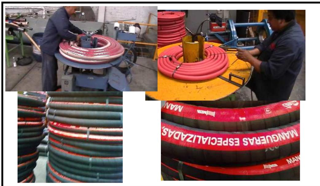
*Figura 2.7. Según las dimensiones de la manguera este de embobina y se empa de manera distinta*
