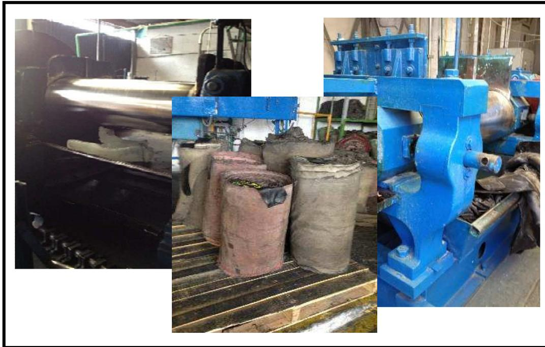
***Figura 2.2. En el área de mezclado el hule se prepara en tiras y se resguarda en liners para evitar que se contamine***
