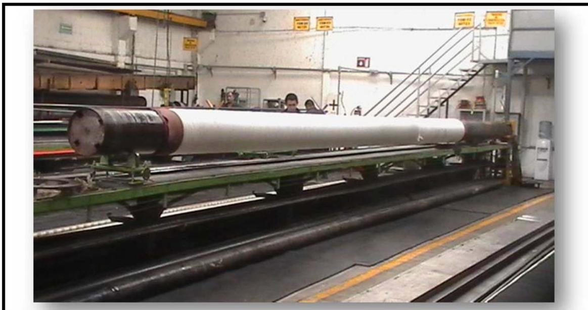
*Figura 3.16. Las líneas de construcción tienen una longitud de 16 metros y una mesa en donde se colocan camas de rodillos para evitar la deformación del tubo que se utiliza como molde*
