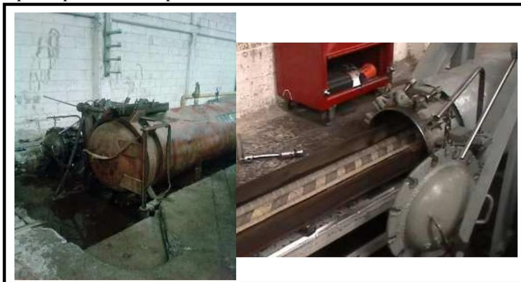
*Figura 2.5. El tiempo de vulcanizado se determina de acuerdo al tipo de material y las dimensiones del producto*
