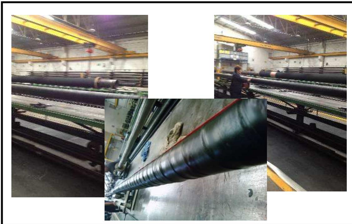
*Figura 2.4. En el área de construcción se fabrican las mangueras manualmente y se acondicionan de acuerdo a los requerimientos del usuario final*
