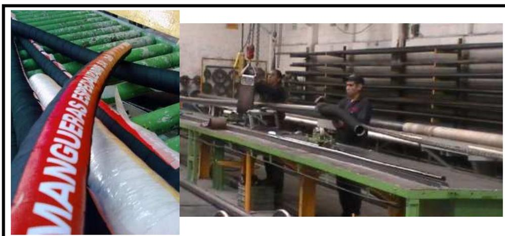
*Figura 2.6. La manguera extraída en esta área pasa a zona de espera para el siguiente proceso*
