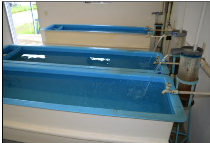
Figura 3.5 Fotografía de las incubadoras con canaletas de fibra de vidrio del laboratorio de incubación del CEIEGT (UNAM-FMVZ, 2012 b)
