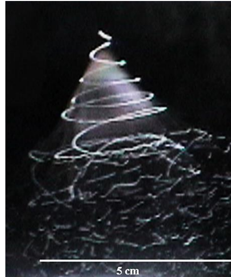
Figura 2.4. Izquierda, diagrama que ilustra las inestabilidades de curvatura que aparecen en un jet de líquido electrohilado. Derecha, fotografía de las inestabilidades de curvatura observadas en el jet de PEO durante el electrohilado [36].
