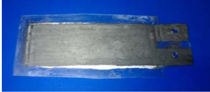
Figura 4.2. Celda piezoeléctrica, malla de PEO 750 al 6% w/w en etanol/agua (80/20) con partículas de cuarzo (20% w/w respecto al PEO 750 ), electrodos de pintura de grafito y encapsulado de Mylar.
