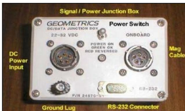
Figura 27. *Junction Box* para el sistema G877 [Manual del operador, G877].
