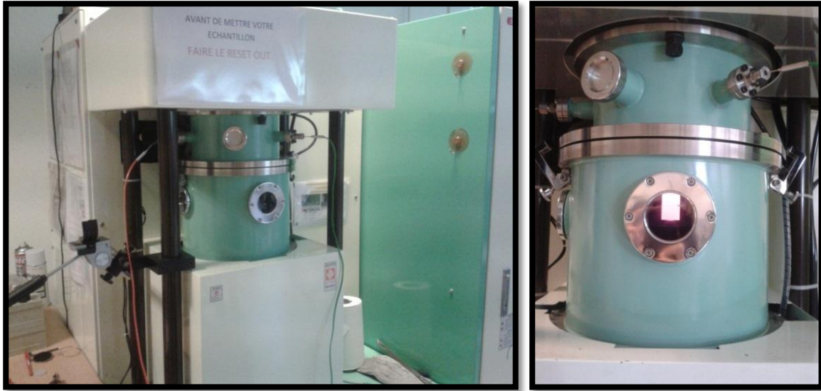
Figura 2.3 Imagen del dispositivo “Spark Plasma Sintering” (SPS); DR. SINTER® LAB Series modelo SPS-515S
