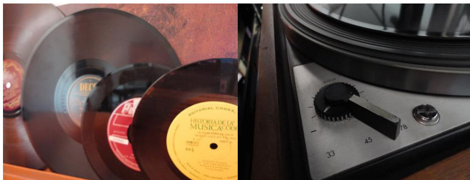
Figura 3. Velocidades de los LP 33, 45 y 78 rpm, y equipo de reproducción.
