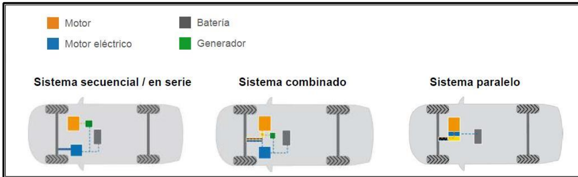
FIGURA 3 “TIPOS DE PROPULSIÓN EN VEHÍCULOS HÍBRIDOS”
