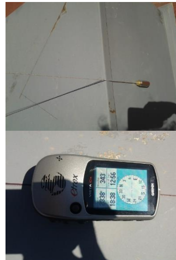
Fig. 45. Orientación norte-sur con plomada y GPS.
