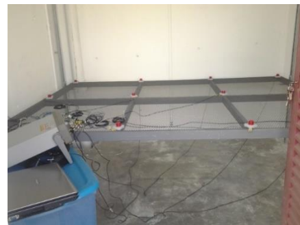
Fig. 48. Colocación de instrumentos de medición y TLNA en la bodega de experimentación.
