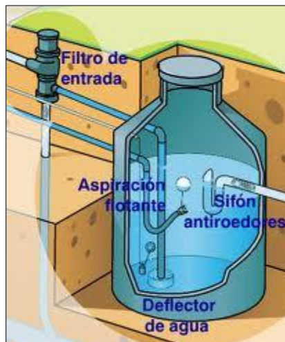
Fig. 3.7 Sugerencia del contenedor para almacenamiento
