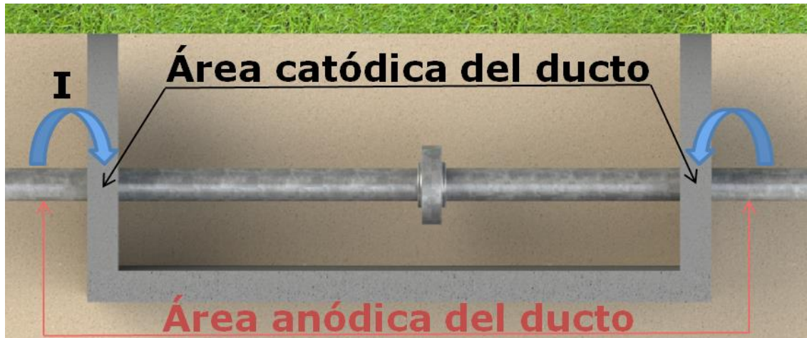
Figura 9 Celada de corrosión por electrolitos de concreto y suelo
