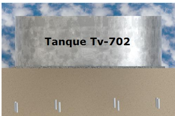
Figura 35 Tanque 1: plancha de 40 cm de espesor
