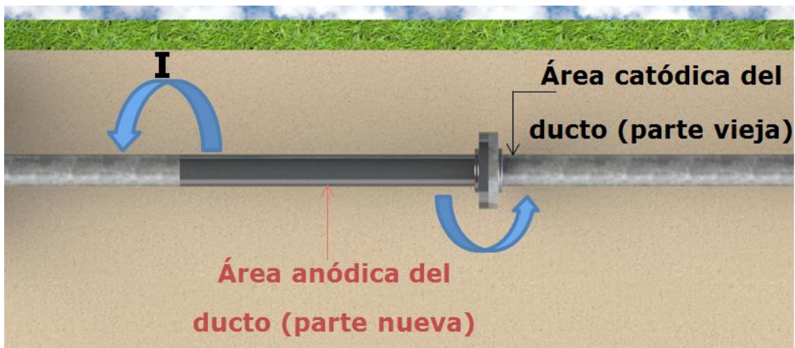
Figura 10 Corrosión causada por antiguos y nuevos tipos de acero
