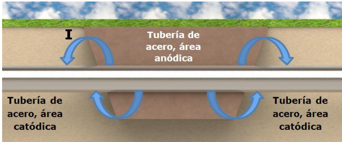
Figura 8 Celda de corrosión causadas por diferentes suelos
