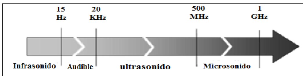
Figura 6. Espectro de Frecuencia de las Ondas Sonoras [Mendoza, 2008].
