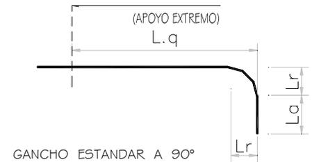
**Ilustración 4: Detalles y especificaciones de dobleces en estribos.**
