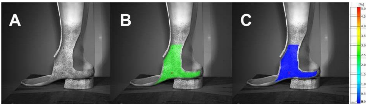
Figura 38. Verificación de la preparación superficial de SS. A) Preparación superficial. B) Análisis del tamaño de la máscara. C) Análisis de deformación.
