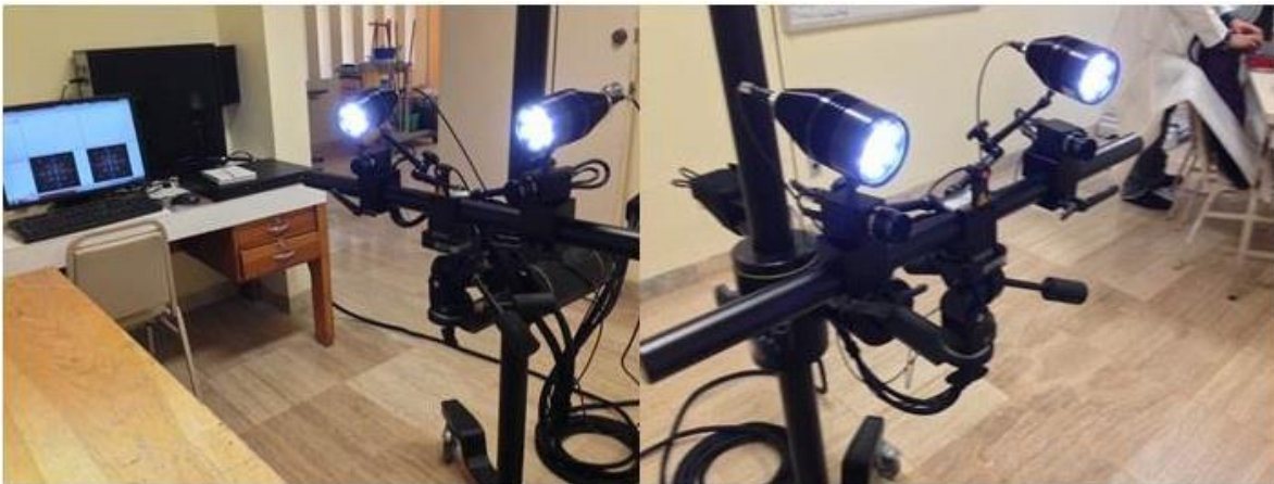
Figura 36. Configuración de las lámparas establecida para todas las mediciones realizadas en este trabajo.
