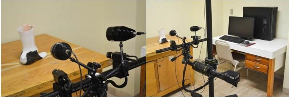
Figura 31. Montaje y acomodo del equipo para llevar a cabo la prueba de medición de ángulos de la pared del sistema protésico.
