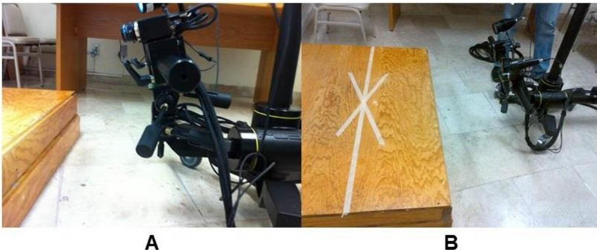
Figura 48. Montaje para la prueba dinámica durante la fase de apoyo. A) Colocación de las cámaras del sistema de medición respecto a las tarimas. B) Guías establecidas para que el paciente caminará sobre ellas.
