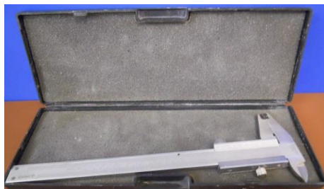
Figura 16. Vernier marca TRUPER utilizado para la medición del tamaño de pixel.
