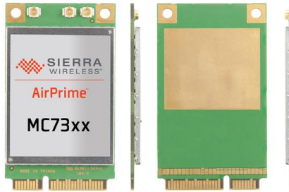
Figura Anexo C. 1 Módulo genérico de la familia MC73XX con dimensiones: 51 x 30 x 4.5 mm
