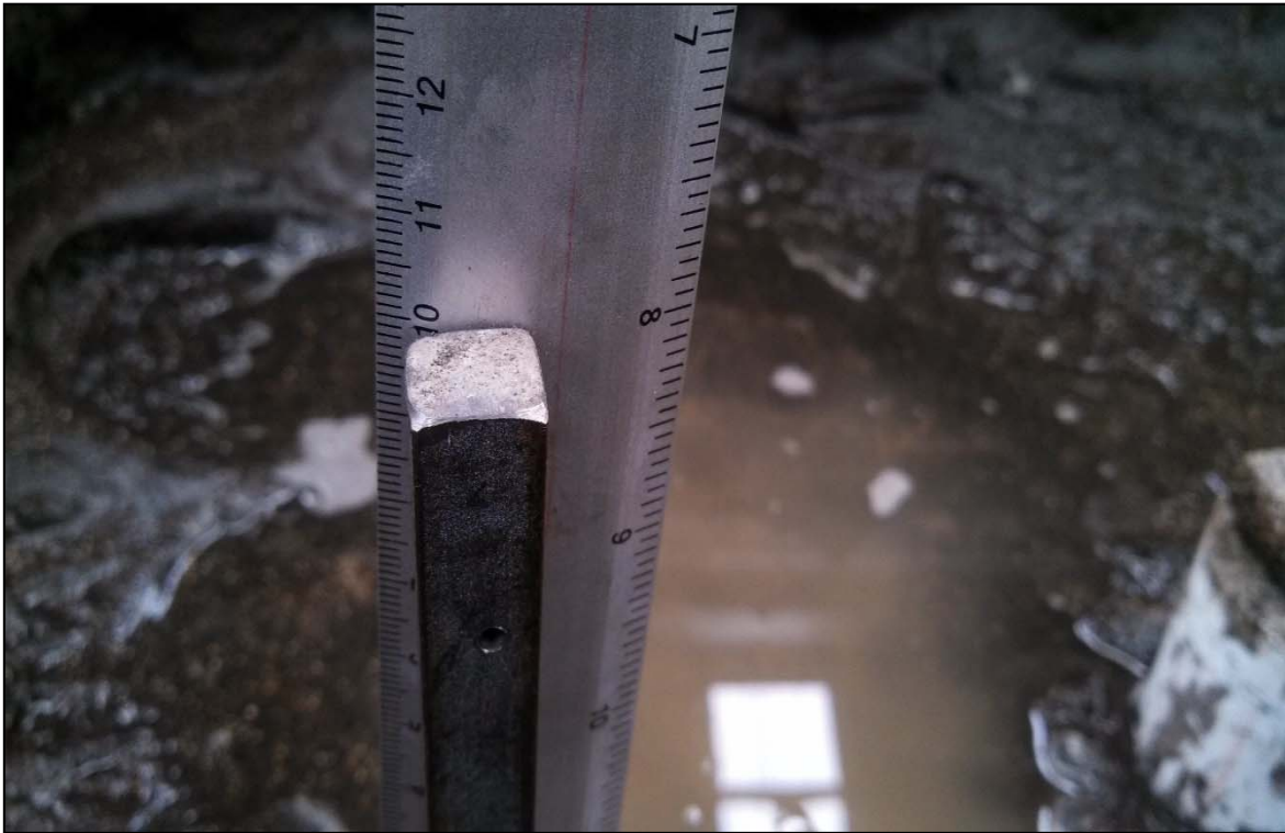
Figura 3.3a Regla referenciada a las elevaciones del modelo, en el punto A
