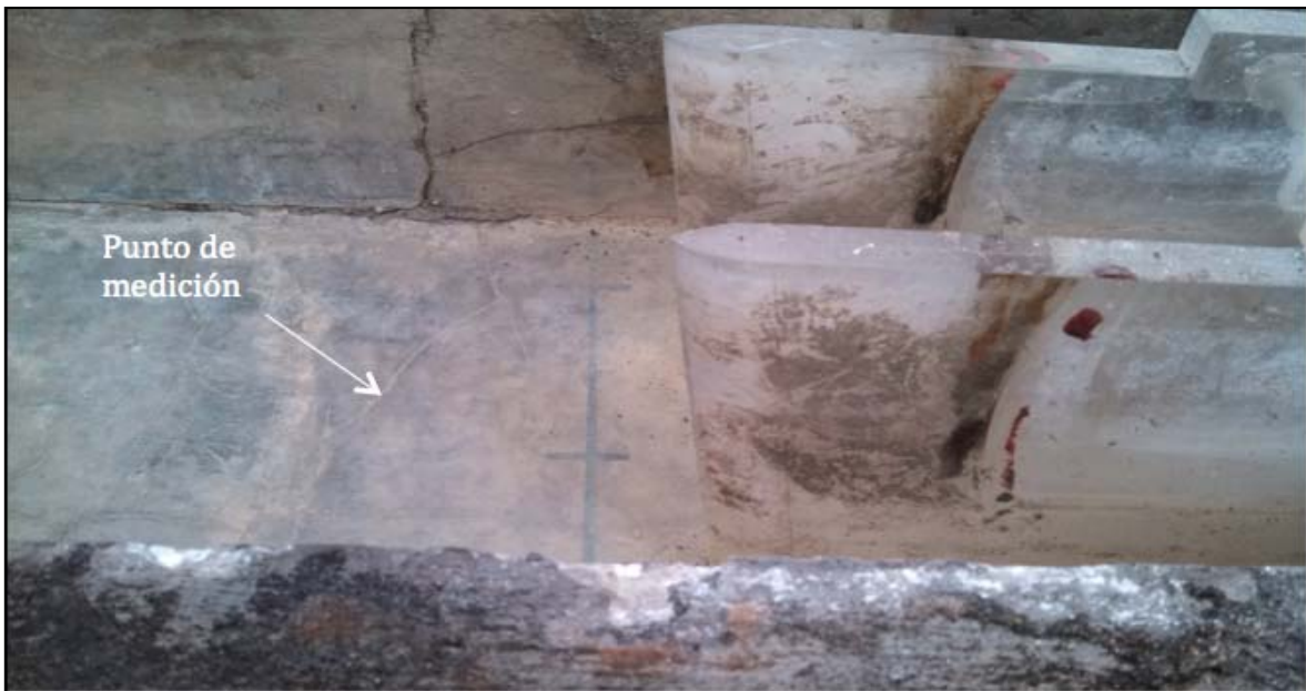
Figura 3.6 Pendiente de la nariz de las pilas del modelo y localización del punto P en el Canal de Margen Izquierda
