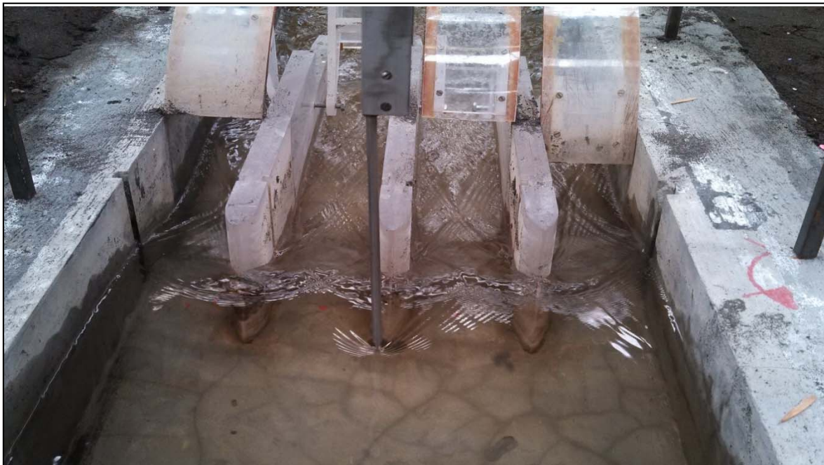
Figura 3.4b Ondas estacionarias y remanso producidos por las pilas
