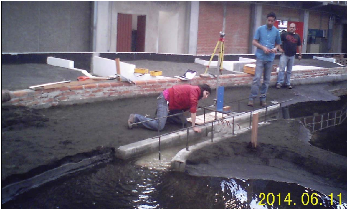
Figura 3.4a Lectura en el punto P con ayuda de un limnómetro
