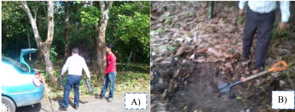
**Imagen 6.** A) Preparación de equipo para el muestreo., B) se puede observar que se limpió el área de toda materia orgánica buscando solo obtener suelo.
