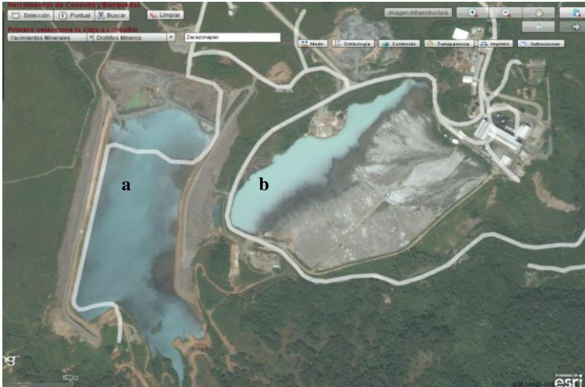
Figura 2.3. Vista aérea de la planta cooperante; a) Presa de jales 2; b) Presa de jales 1 (SGM, 2012)
