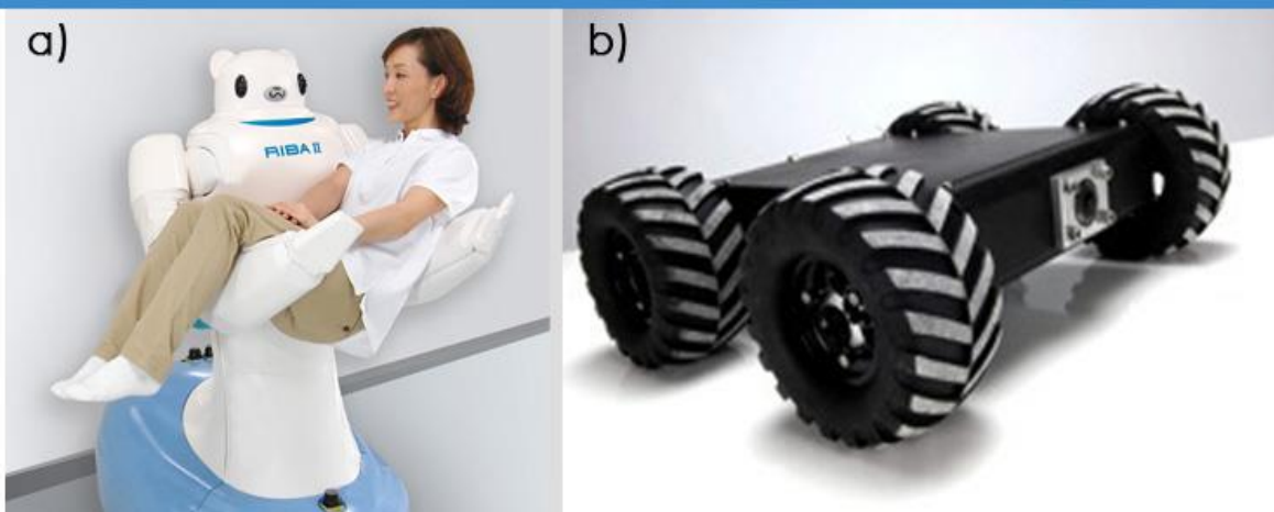
Fig. 1.9 a) RIB. Robot Móvil que tiene como principal uso transportar a pacientes b) Bot de Eventronic. Robot que inspecciona tuberías.
