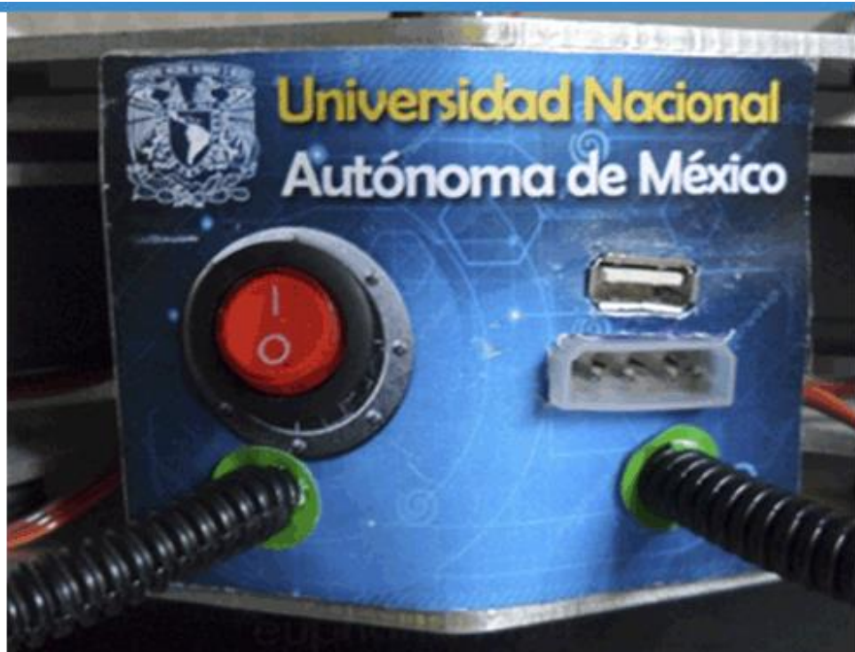
Fig. 7.15 Conector tipo preripheral. Foto del área de control manual.
