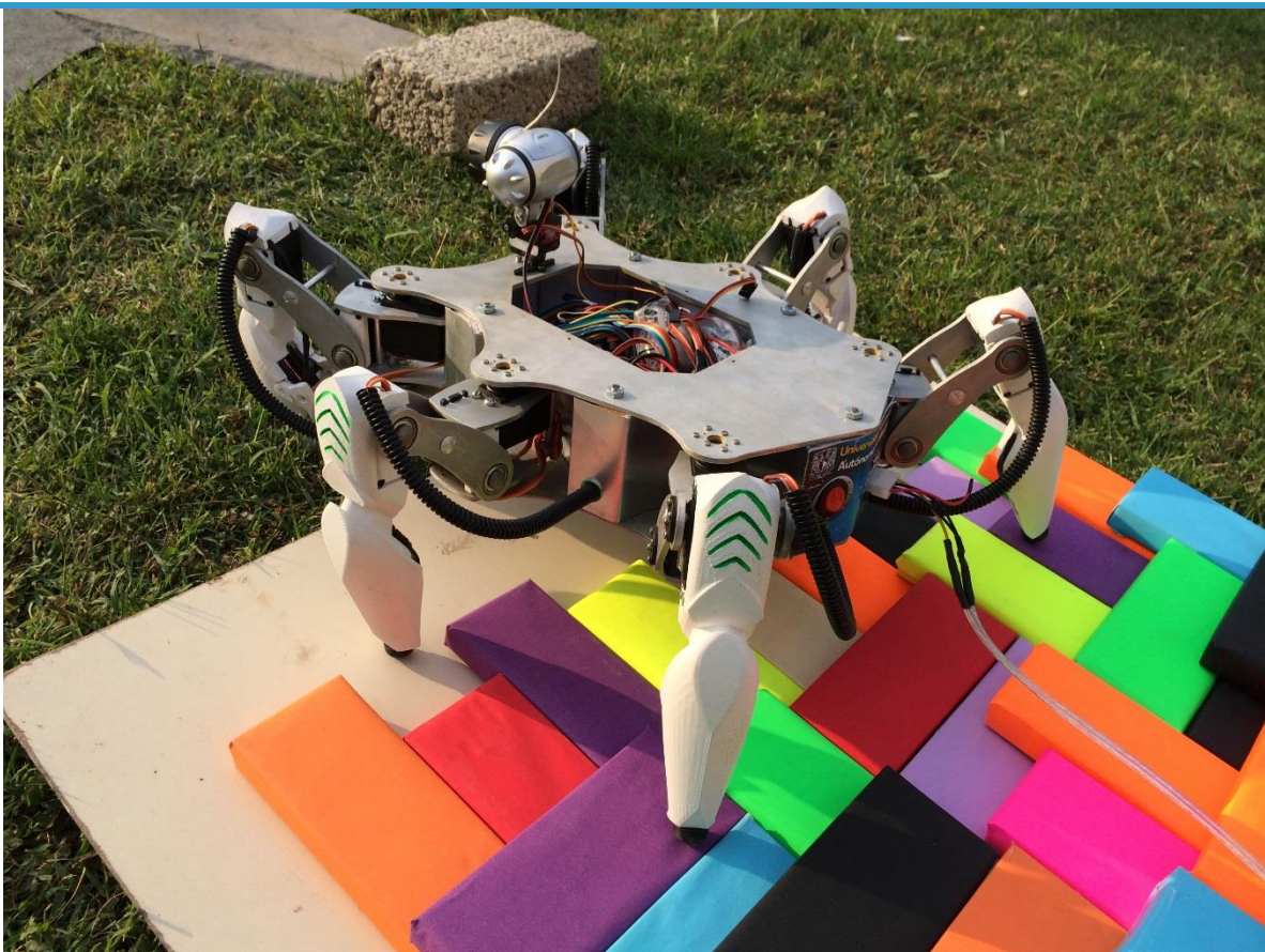
Fig. 8.25 Fallo en la prueba 4.1. La pata se dobló y evitó continuar con la caminata.
