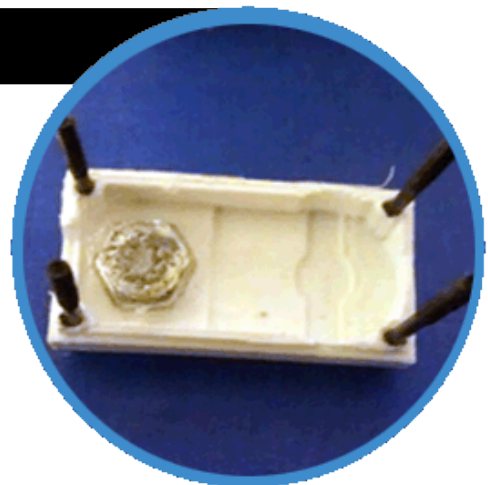
Fig. 7.6 Tapa del servomotor 3D con la tuerca incrustada.
