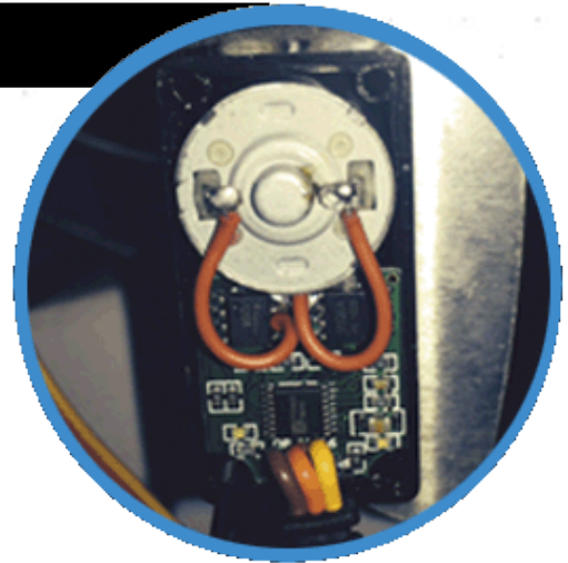
Fig. 7.4 Vista del servomotor sin la tapa trasera.
