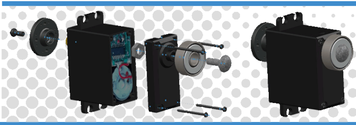
Fig. 7.25 Ensamble del servomotor con su eje modificado.
