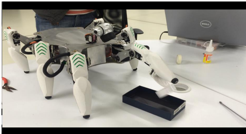
Fig. 8.15 El objeto es levantado y la pata se dirige al punto donde se quiere dejar el objeto.
