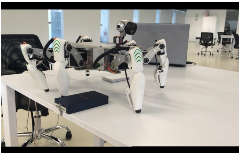
Fig. 8.6 El Grupo 1 conformado por las patas 1,4 y 5 empiezan a elevarse. Mientras que las patas Grupo 2 (patas 2,3 y 6) se encuentran en el suelo, regresando a su posición original, desplazando al robot.
