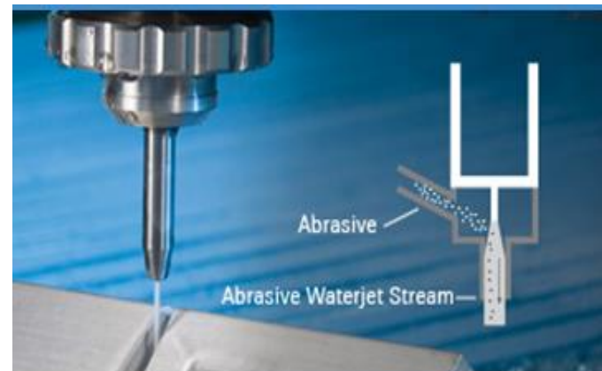
Fig. 7.19 Proceso de corte por chorro de agua.
