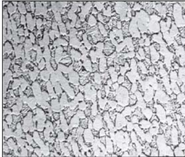
Figura 1. “estructura recocida” de una aleación Ti-6Al-4V granos equiaxiales [7].
