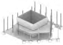
FIRME DE CONCRETO Y ENTREPISO DE PLACAS ALVEOLARES
