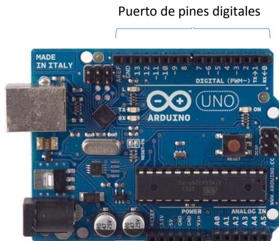
Figura 4.14.- Puerto digital. ArduinoUNO. Sistema de interfaz [32]
