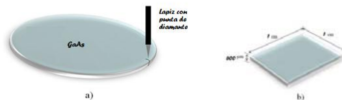
Figura 24 Inciso a) esquema del corte de oblea de GaAs. Inciso b) esquema de las dimensiones del sustrato de GaAs \langle 100 \rangle (62).
