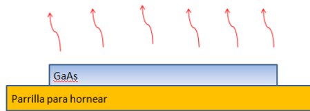
Figura 25 Esquema del cocido del sustrato, después de realizarle la limpieza.
