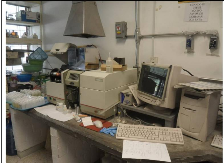
Fig. 11 Fotografía que muestra el espectrofotómetro de absorción atómica donde se realizó el análisis de la concentración de sodio en suelo y del material vegetal de *A. hypochondriacus*.
