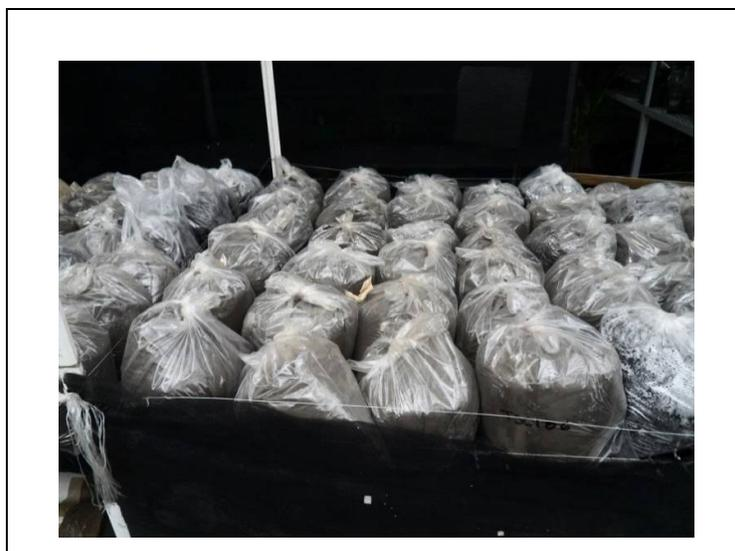
Fig. 12 Fotografía que muestra la previa toma de la muestra compuesta por bloque de los suelos de cada maceta depositados en bolsas de poliuretano.
