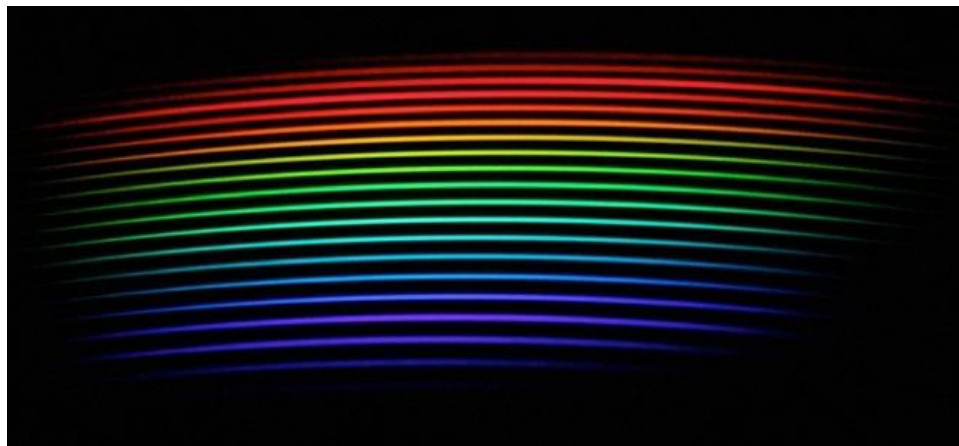
Figura 1.2.5.1.- Espectro producido por una rejilla Echelle
