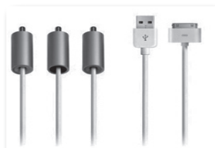
Cables RCA que mandan la señal de la ipod a la televisión
