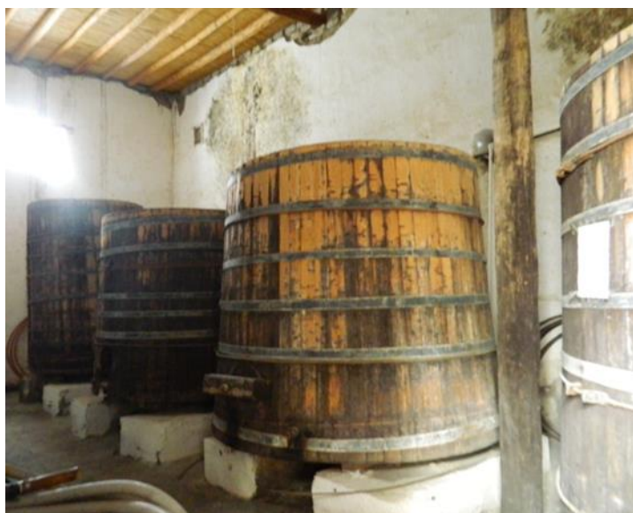
Fotografía 19 Tanques de fermentación, capacidad de 15 000 lts, ubicadas en Hacienda Perote Abril 2014
