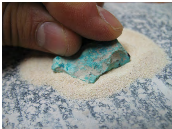
Figura 134. Desgaste experimental con ayuda de abrasivos: basalto y arena.
