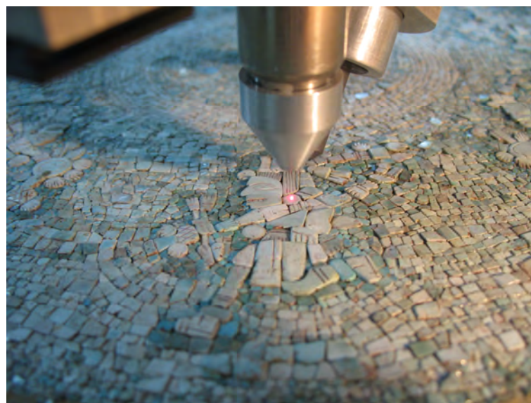
Figura 118. Ejemplos del análisis puntual de piezas del Templo Mayor con Fluorescencia de Rayos X (tomado de Ruvalcaba et al. , 2013).
