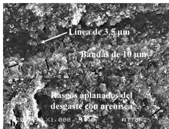
Figura 187. Superficie de incrustación de Nevado de Toluca a 100x (a) y 1000x (b).
