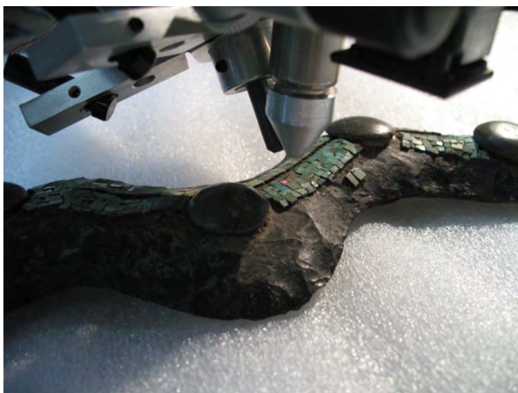
Figura 118. Ejemplos del análisis puntual de piezas del Templo Mayor con Fluorescencia de Rayos X (tomado de Ruvalcaba et al. , 2013).
