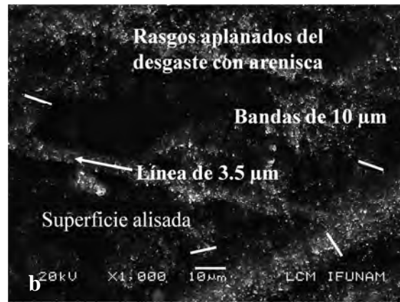
Figura 188. Desgaste experimental con arenisca a 100x (a) y bruñido con piel a 1000x (b).
