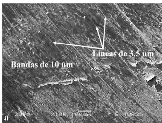
Figura 186. Desgaste experimental con arenisca, pulido con pedernal y bruñido con piel a 100x (a) y 1000x (b).
