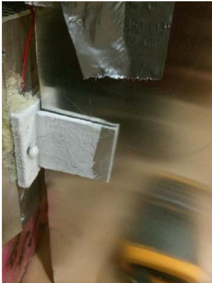
Figura 47. Enfriamiento del aluminio al entrar en contacto con el dissipador
