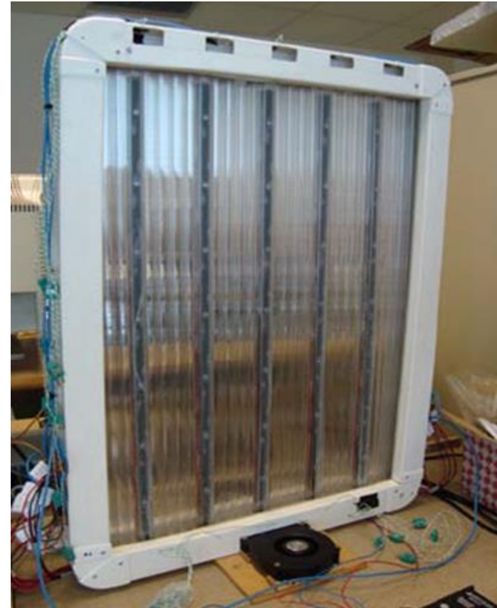
Figura 18 ventana termoactiva. Prototipo final. Fuente: Nectalí Fernández, Alejandro
