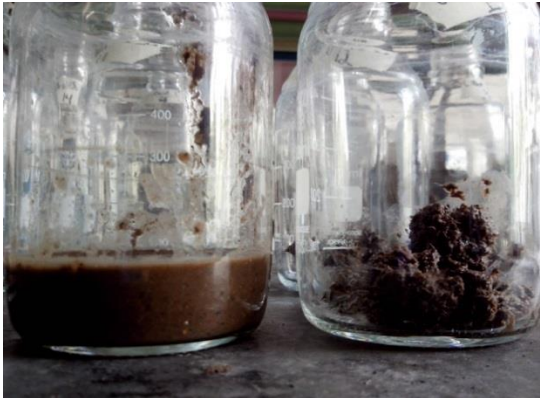
Figura 3-5. Muestras de digestión húmeda 10% ST (izquierda) y digestión seca 25% ST (derecha)
