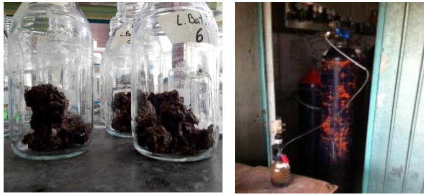
a) b) Figura 3-9. (a) Reactores con FORSU, (b) Reactor conectado al tanque de N 2 para crear atmosfera anaerobia
