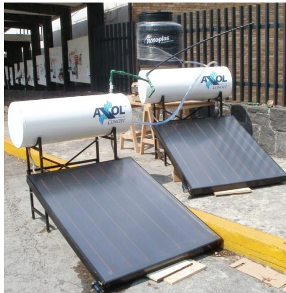
Fig. III-10. Instalación del sistema solar de ACS durante las pruebas en México D. F. (en C. U.)
