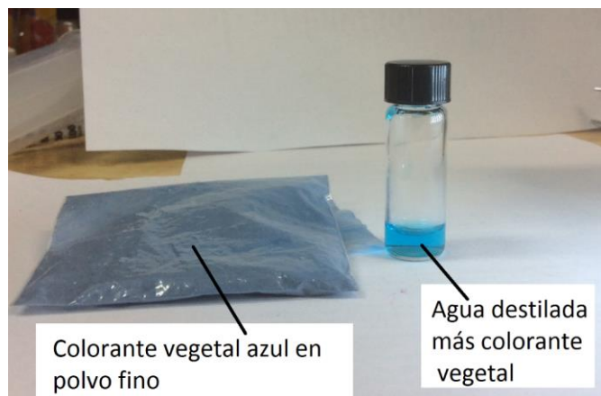
Figura B.6 Líquido teñido por colorante vegetal azul, utilizado como medio de contraste dentro de los microcanales del dispositivo microfluídico de prueba.
