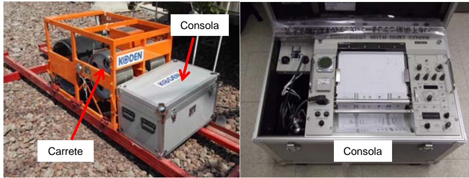
Fig. 4.b.1. Consola y carrete del KODEN.
