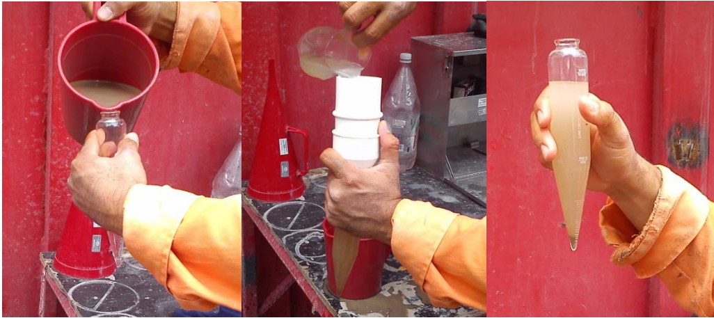
Fig. 4.s. Prueba de contenido de arenas.
