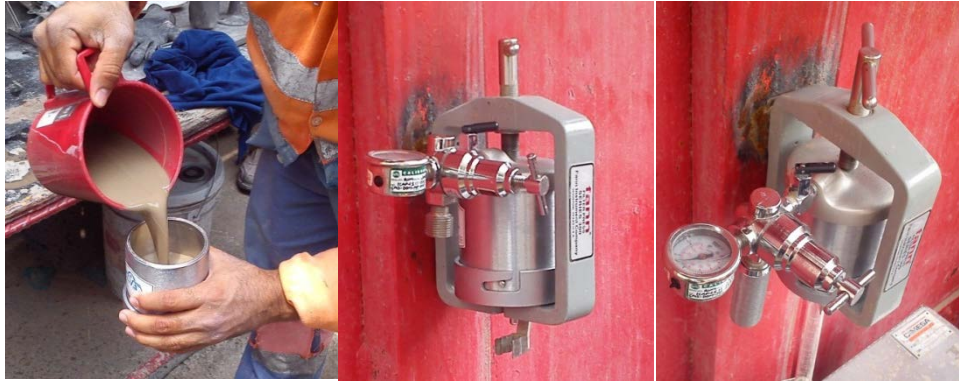
Fig. 4.q. Prueba de película impermeable (cake).
