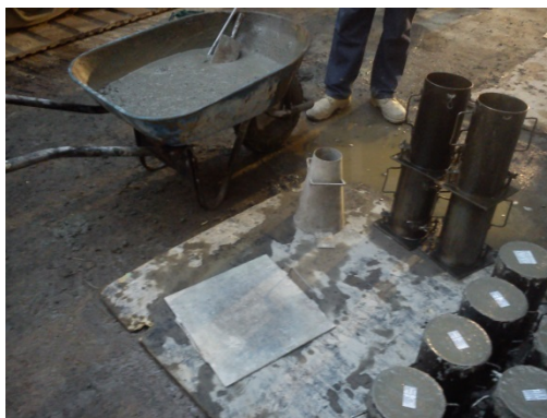
Fig. 4.r.1. Equipo estandarizado para la prueba de revenimiento y resistencia.
