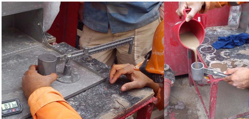
Fig. 4.p. Prueba de densidad con la balanza Baroid.
