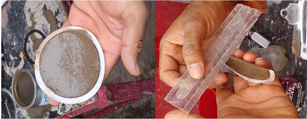
Fig. 4.r. Medición de película impermeable sobre un papel filtro (espesor).
