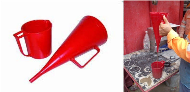
Fig. 4.o. Prueba de viscosidad con el cono de Marsh.
