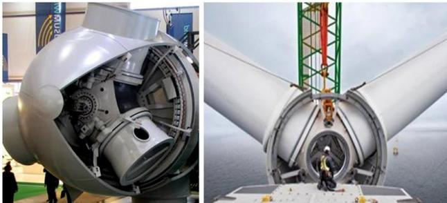
**Figura 33** Exposición interior del buje donde se observan los mecanismos de unión para las palas.
