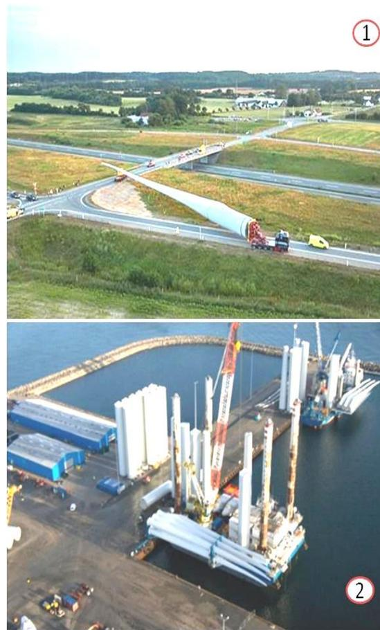
**Figura 58.** 1. Transporte por vía terrestre de una aspa, 2. Acondicionamiento portuario que alberga las piezas de un aerogenerador para su posterior traslado a altamar.
