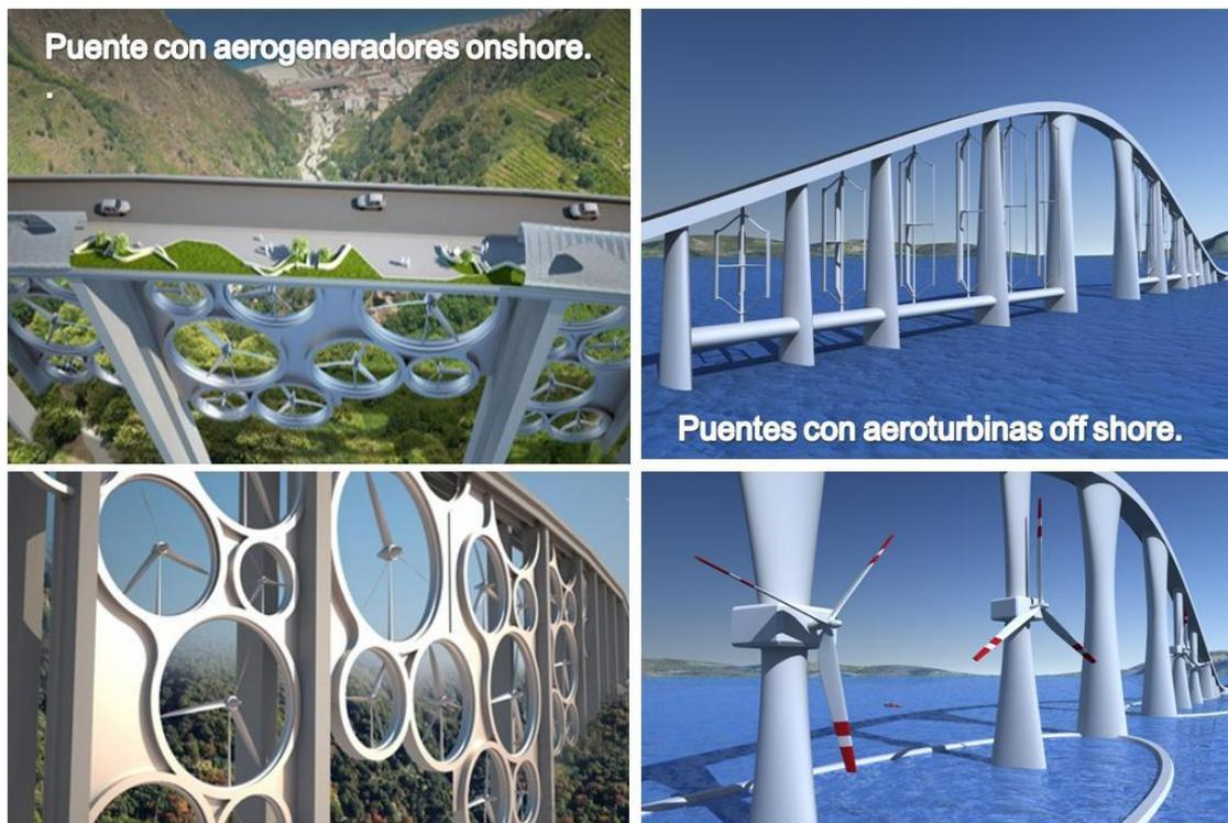
**Figura 74.** Conceptos de puentes para la integración de turbinas eólicas en la subestructura, para el aprovechamiento de los vientos cruzados a los que son sometidos diariamente dependiendo el tipo de construcción. “Wind Turbine Bridge Transforms”. Imágenes tomadas del sitio. <http://inhabitat.com/solar-wind-turbine-bridge-repurposes-viaduct-for-public-space/>. (Fecha de actualización 28 de agosto del 2014).
