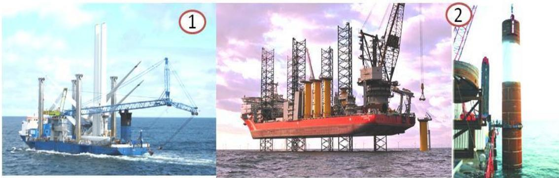
**Figura 61.** 1. Buque “Jack up” transportando piezas de aerogeneradores, 2. Plataforma “Jack up” hincando pilote en altamar.
