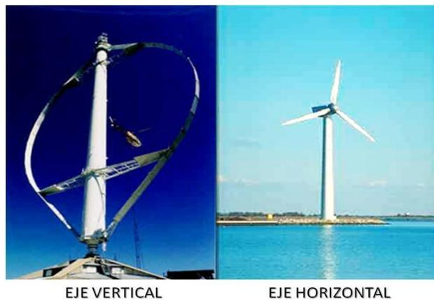
**Figura 30.**Tipos de aerogenerador según la orientación de su eje.
