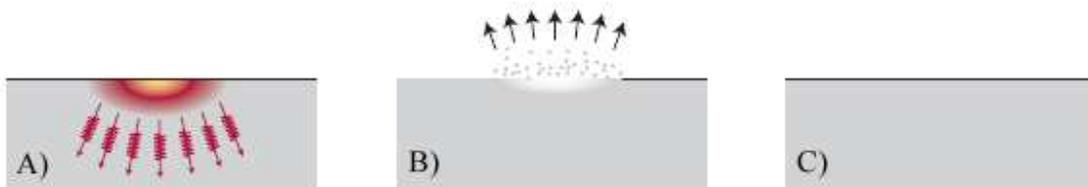
Figura 3-4: Representación de los procesos transitorios en un semiconductor excitado ópticamente con un pulso ultracorto. A) Difusión térmica, B) Ablación. C) Resolidificación o condensación.
