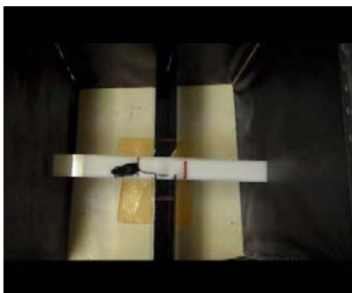
Figura 9. Laberinto en cruz elevado. Esta compuesto por 4 brazos, cada uno tiene un ángulo de 90° de separación, cada brazo mide 5X30 X15.
