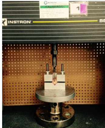
Fig. 23 Colocación de la muestra en maquina INSTRON
