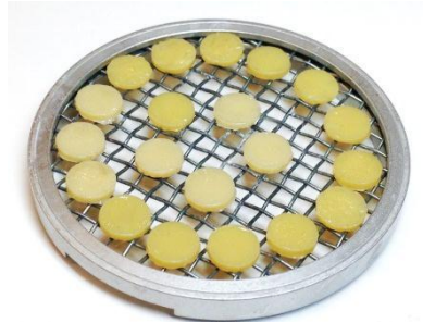
Fig. 6 Colocación de resina adoro en rejilla
