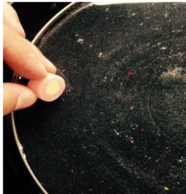
Fig. 13 Pulido de la superficie en pulidor metalográfico.
