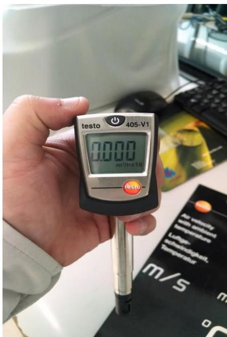
Figura 24. Anemómetro empleado para la medición de propiedades del aire.
