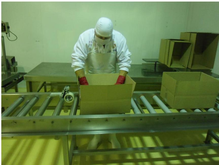
*Figura 34.* Proceso de armado del envase para el producto terminado.
