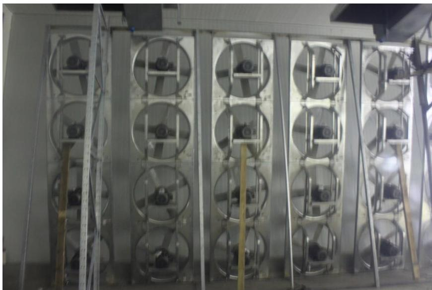
*Figura 51.* Ventiladores para generar ráfagas de viento dentro de los túneles.
