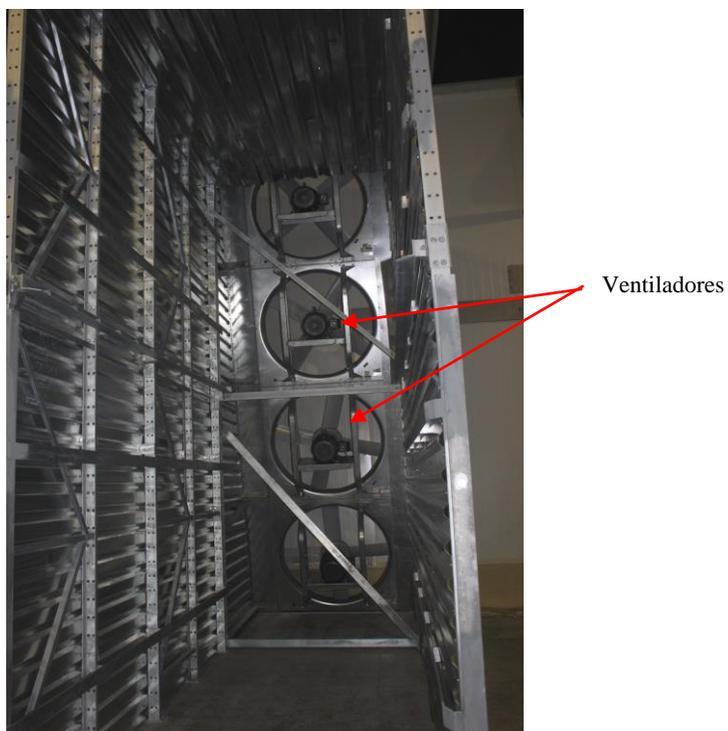
*Figura 21.* Ventiladores generadores de la ráfaga de aire frío.
