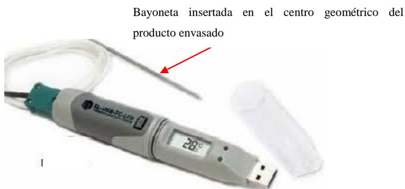
*Figura 26.* Termopar empleado para monitorear la temperatura del producto.
