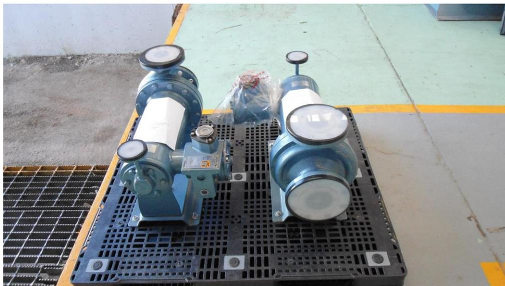
*Figura 16.* Bombas empleadas para la recirculación del amoníaco.
