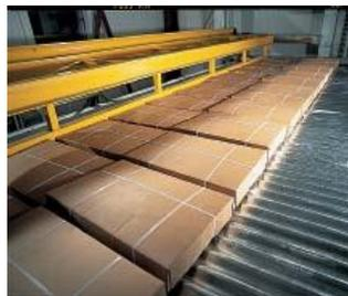
*Figura 45.* Espaciado de las cajas mediante un brazo mecánico (GEA, 2012).
