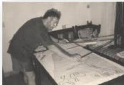
Fig. 11 Pantógrafo
