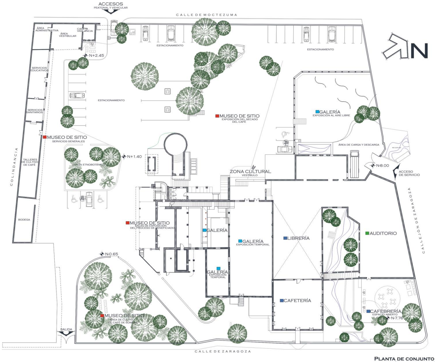
35. Planta arquitectónica del conjunto con la propuesta de uso y su ubicación dentro de los edificios del beneficio de café “La Mata”.
