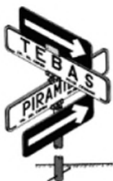
Colocación de las señales de nomenclatura complementadas con flechas de sentido de circulación.
